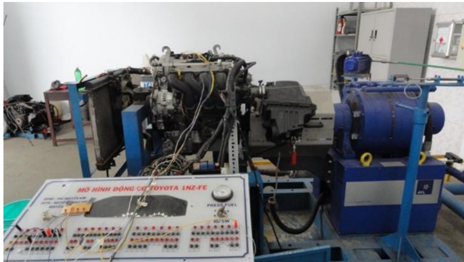
Hình 5.2: Thực nghiệm đánh giá hiệu quả làm việc của hệ thống đánh lửa hỗn hợp điện dung - điện cảm
