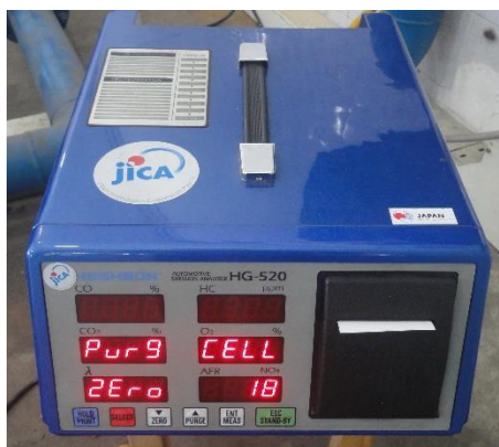
Hình 4: Thiết bị phân tích khí thải HG-520 của hãng HESHBON - Hàn Quốc [69]
